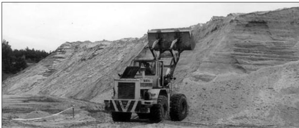
Rys. 24. Ściana eksploatacyjna – urabianie kopaliny ładowarką
