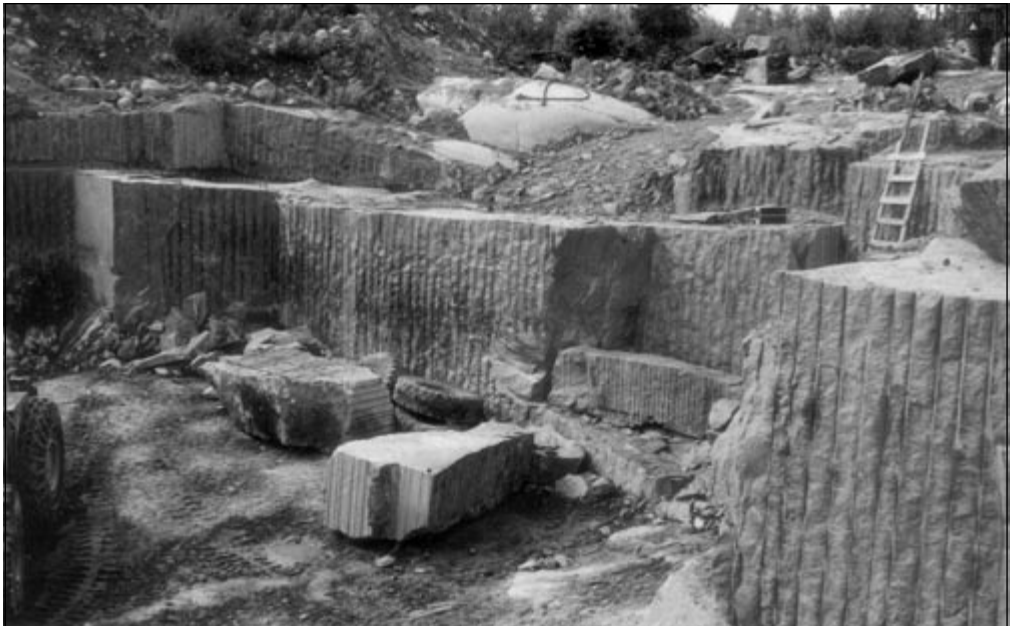
Rys. 7. Kamieniołom, fragment wyrobiska z odspojonymi blokami
