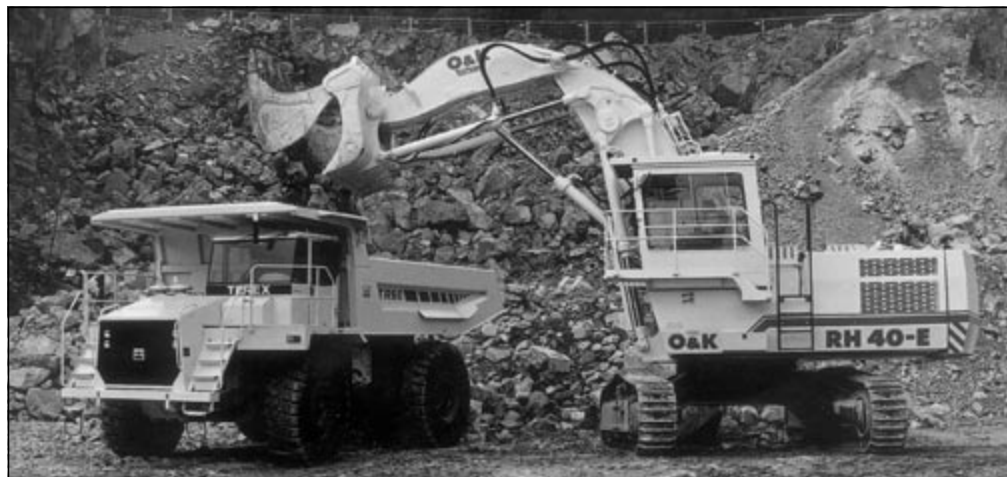
Rys. 12. Ładowanie urobku koparką jednoznaczyniową
