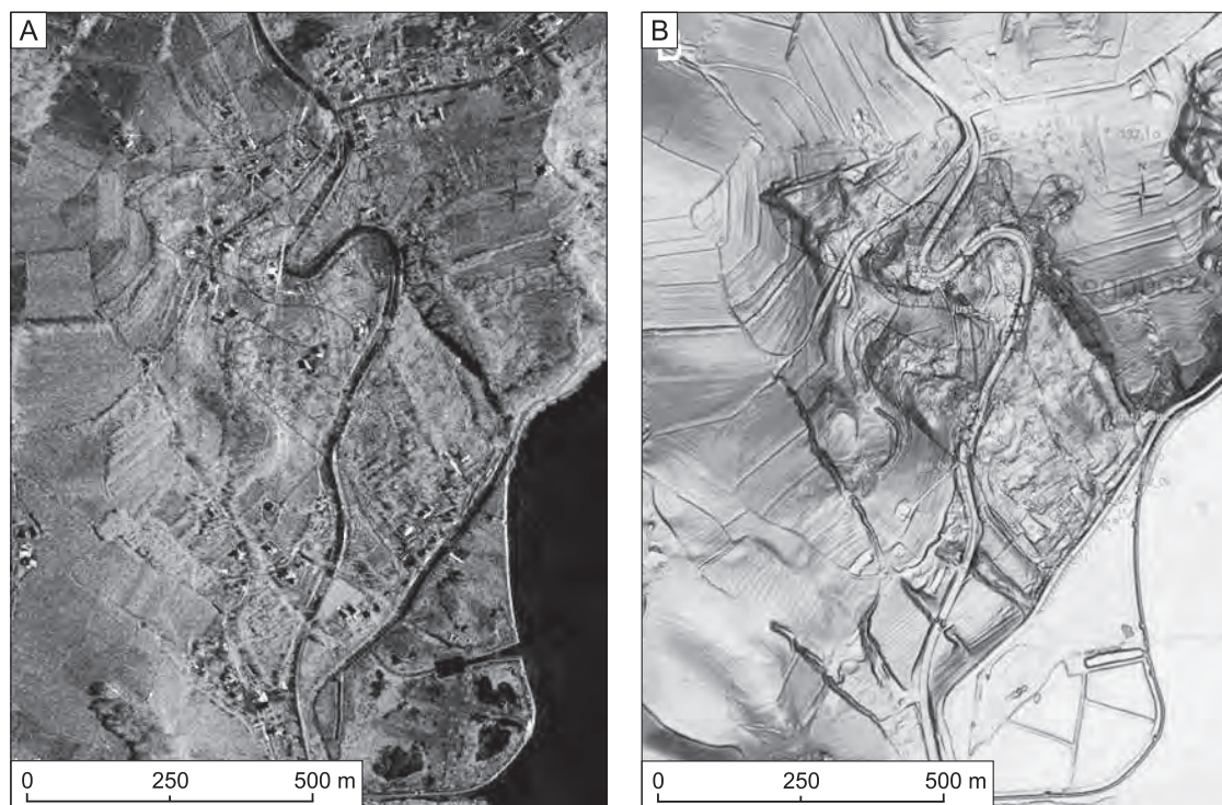
Fig.1. A. Obraz amplitudowy osuwiska Just zarejestrowany przez satelitę TerraSAR-X w trybie Staring Spotlight (20 lutego 2015 r.). B. Ukształtowanie powierzchni osuwiska wyznaczone na podstawie danych z lotniczego skaningu laserowego (projekt ISOK). Zasięg osuwiska według Wójcika i Nowickiej (2010)
