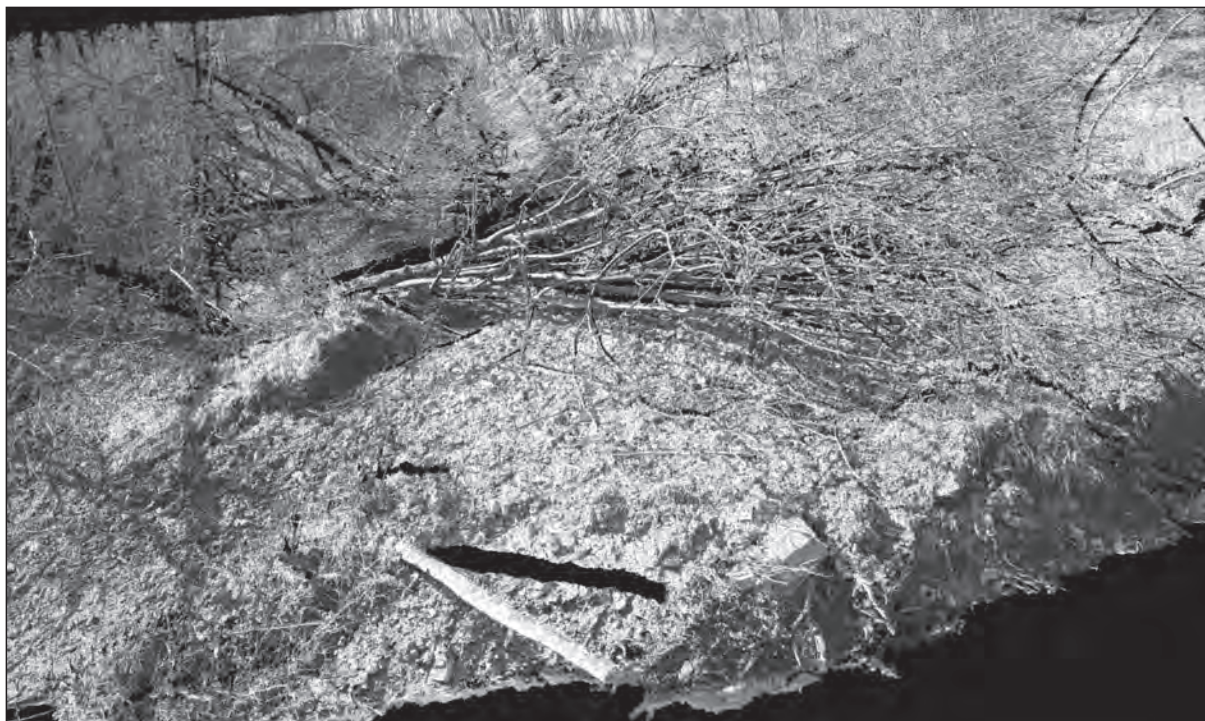
Fig. 2. Uzyskana w wyniku skanowania chmura punktów – czoło osuwiska (bez filtracji)
