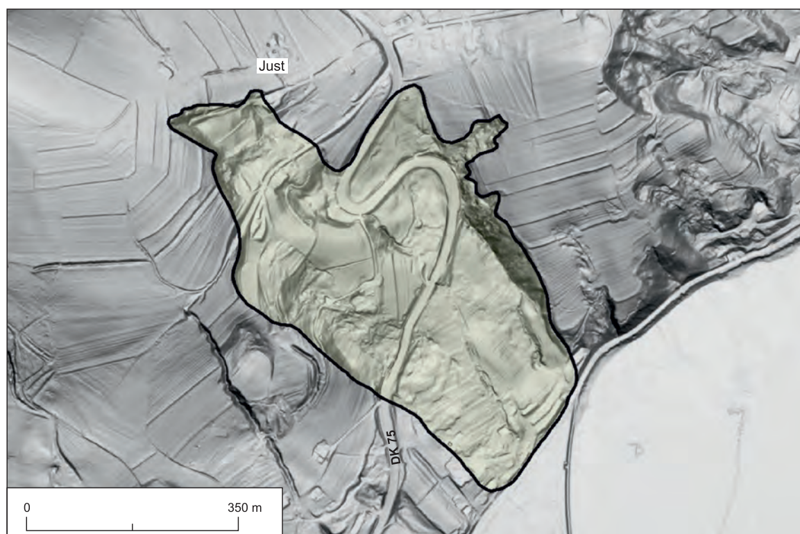
Fig. 2. Osuwisko Just na tle NMT LIDAR
