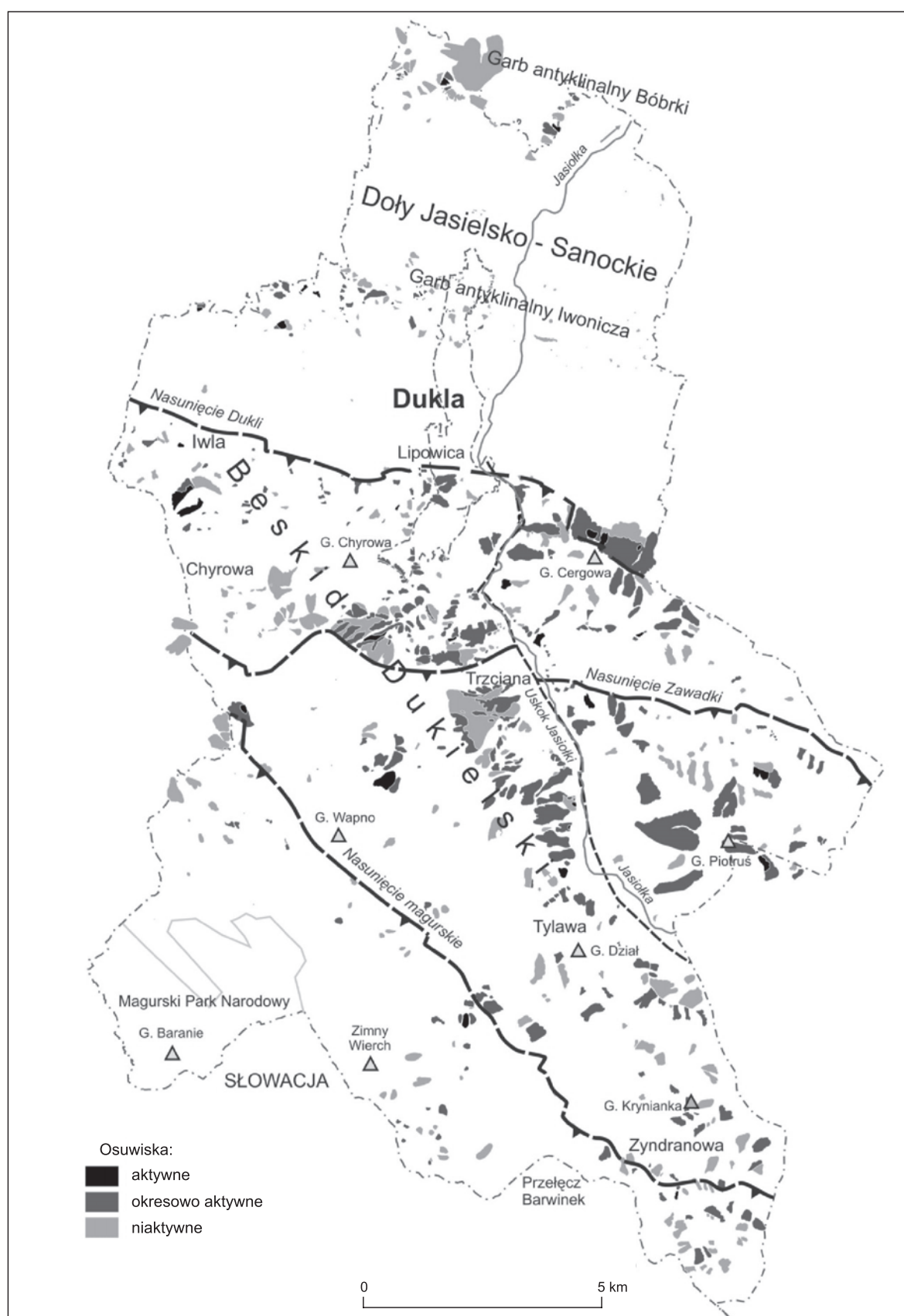
Fig. 1. Szkic geotopograficzny osuwisk (wg Lewandowski i in., 2013, Geoportal SOPO) na podłożu skał serii śląskiej, dukielskiej i magurskiej na obszarze gminy Dukla
