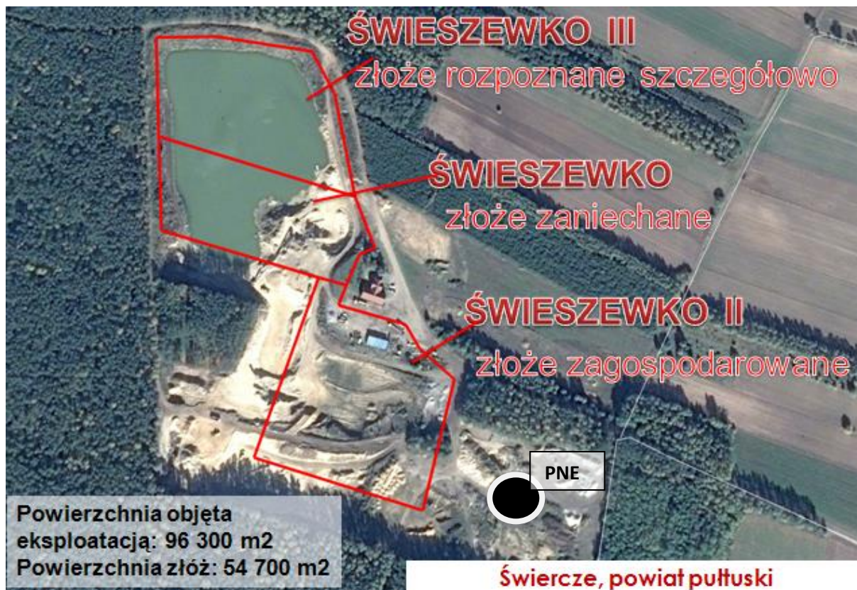
Fot. 1. Eksploatacja znacznie przekraczająca granice złóż oraz rozbieżności w zgłoszonym przez przedsiębiorcę stanie zagospodarowania, a jego stanem faktycznym (widocznym na zdjęciu satelitarnym).
