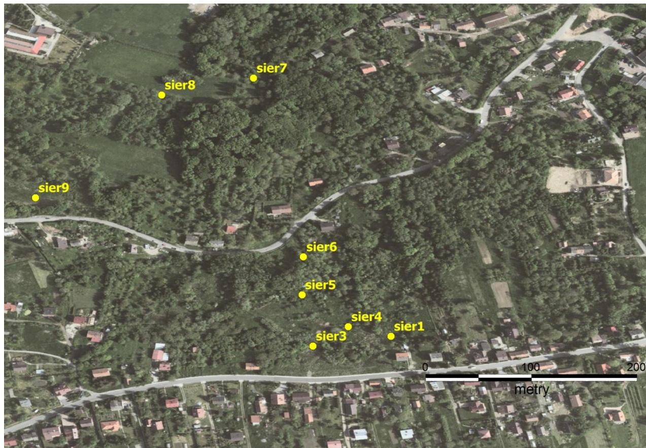
Fig. 1 Lokalizacja punktów monitoringu powierzchniowego na osuwisku w Sierczy
