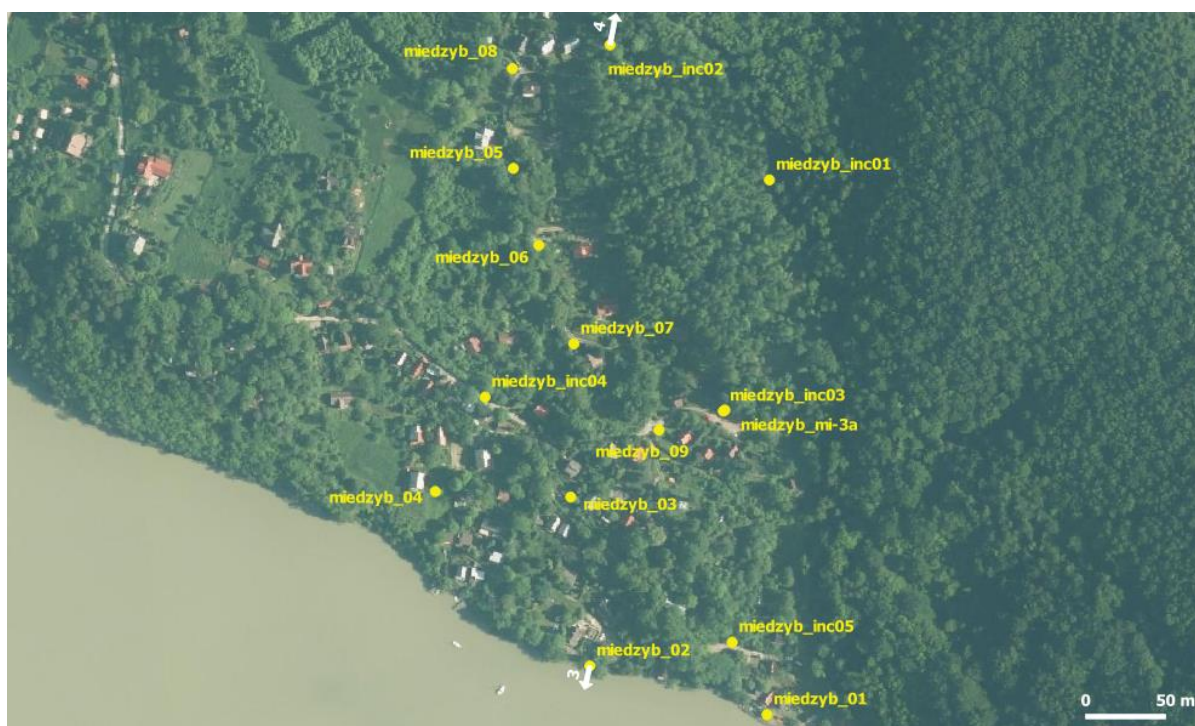
Fig. 1 Lokalizacja punktów monitoringu powierzchniowego oraz wektory przemieszczeń [cm] w okresie 30.03.17-15.01.20 na osuwisku w Międzybrodzie B. Łaski
