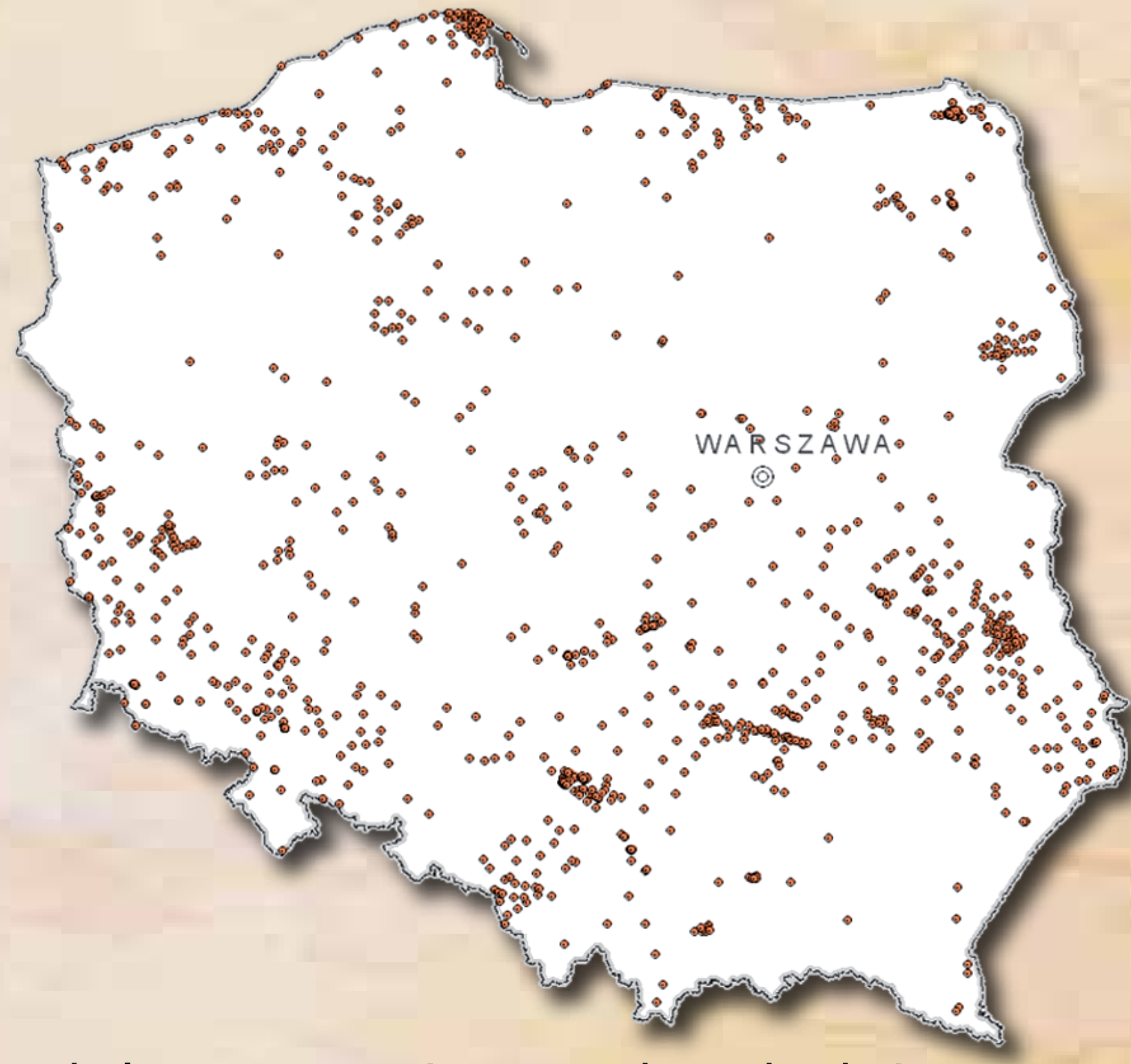
Lokalizacja otworów z wynikami badań porowatości i przepuszczalności
